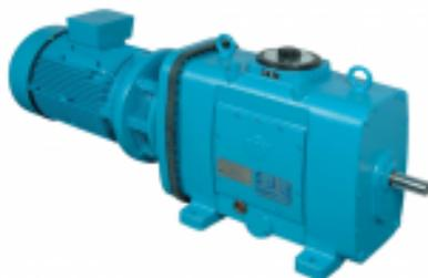
Высокопроизводительный вариатор POSICHAIN System RH от Piv-Drives с устройством цепного привода (технология CVT), функционирует при постоянной выходной мощности с плавной регулировкой скорости и крутящего момента. Для контроля рабочих показателей имеется встроенный датчик со стрелочным указателем уровня на лицевой стороне корпуса редуктора. Практичная модульная система строения дает богатый ассортимент моделей для самых разнообразных приложений.
